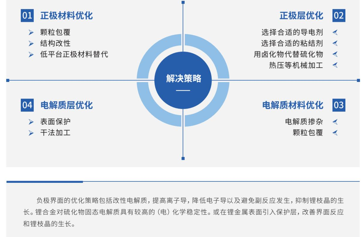
图3.5 硫化物基全固态锂电池正极界面问题解决策略<sup>[5]</sup>
